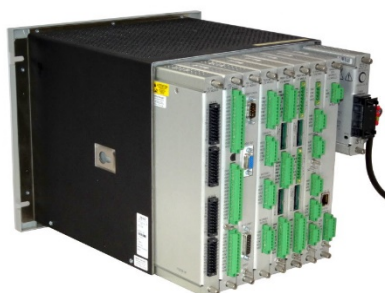
Figure 4: Mini Rack Back View - I/O Modules
